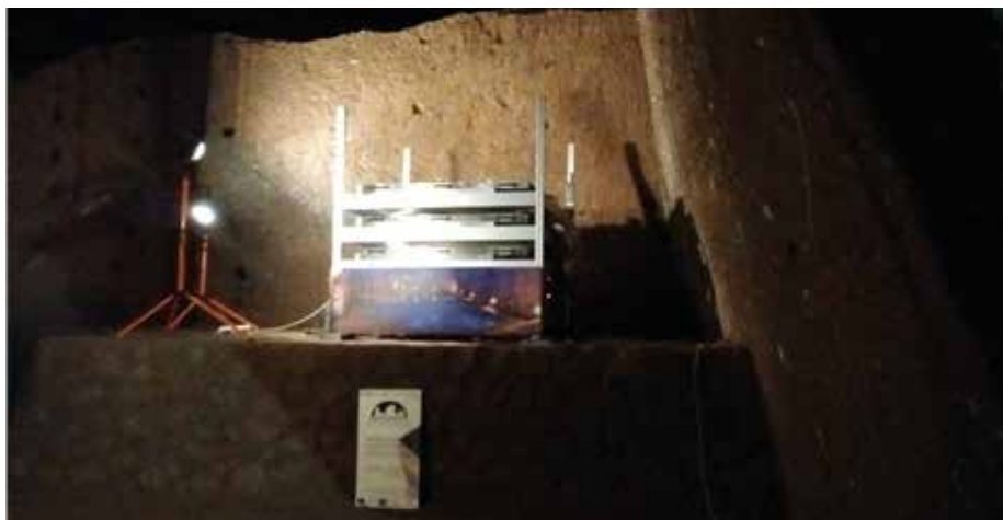
Un rivelatore di muoni installato all'interno del Monte Echia durante la presa dati, ospite dell'Associazione culturale Borbonica Sottterranea
