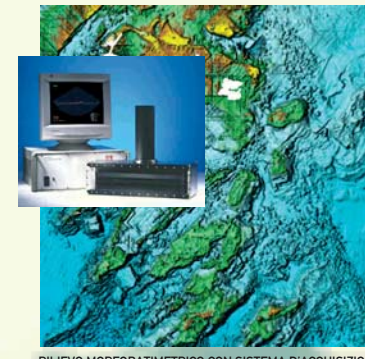
RILIEVO MORFOBATIMETRICO CON SISTEMA D'ACQUISIZIONE MULTIBEAM DEL PARCO SOMMERSO ARCHEOLOGICO DELLA GAIOLA - SOPRINTENDENZA PER I BENI ARCHEOLOGICI DELLE PROVINCE DI NAPOLI E CASERTA - NAPOLI
