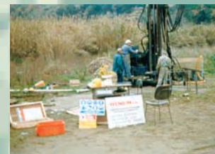
MONITORAGGIO DEL SOTTOSUOLO PRELIEVO DI CAMPIONI INQUINATI BONIFICA EX AREA SIDERURGICA DI BAGNOLI (NA)
