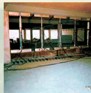
ISTITUTO POLIGRAFICO ZECCA DELLO STATO - ROMA PROVA DI CARICO CON PISTONI OLEODINAMICI
