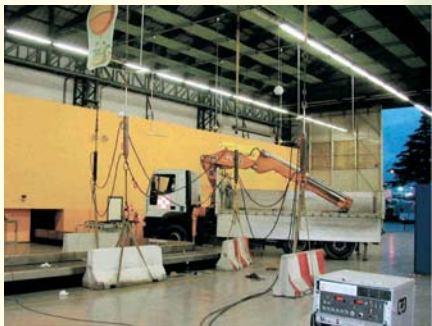
GESAC S.P.A. PROVA A TIRO SU COPERTURA METALLICA DELL'AEROPORTO INTERNAZIONALE DI NAPOLI
