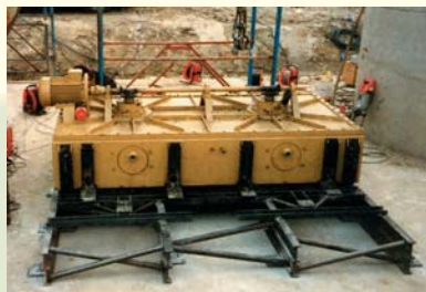
SOCIETÀ ITALIANA CONDOTTE D'ACQUA S.P.A. VIBRODINA UTILIZZATA PER PROVE DINAMICHE FORZATE PER LA DETERMINAZIONE DEI PARAMETRI DINAMICI DI IMPALCATI LINEA FERROVIARIA AD ALTA VELOCITÀ - TRATTA BOLOGNA-VERONA
