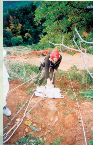
A.N.A.S. S.P.A. - CALABRIA PROVA A SFILAMENTO SU TREFOLI CATANZARO
