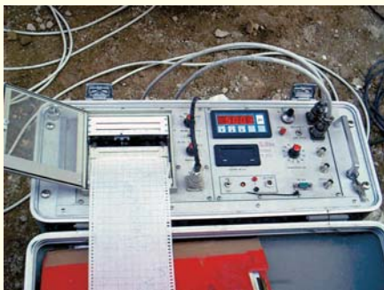
APPARECCHIATURA PER PROVE CROSS-HOLE CANTIERE METROPOLITANA DI NAPOLI S.P.A.
