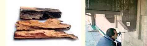
ANALISI DEL DEGRADO BIOTICO. INDAGINI RESISTOGRAFICHE ED ENDOSCOPICHE SU STRUTTURE LIGNEE - PALAZZO DELLA PROVINCIA DI PISA
