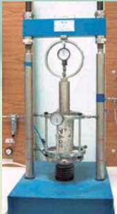
CALCESTRUZZI DETERMINAZIONE DEL MODULO ELASTICO SU PROVINO CILINDRICO
