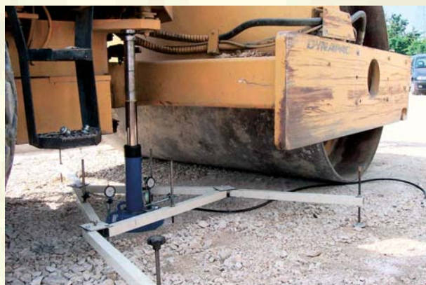
PROVA DI CARICO SU PIASTRA - AEROPORTO INTERNAZIONALE DI NAPOLI
