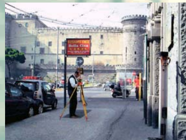
METROPOLITANA DI NAPOLI S.P.A. - MONITORAGGIO ALTIMETRICO DEI FABBRICATI PROSPICIENTI PIAZZA MUNICIPIO, NAPOLI
