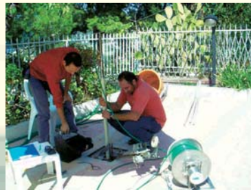
MONITORAGGIO ESTENSO-INCLINOMETRICO DI UN PENDIO IN FRANA NEL CILENTO CONTROLLO STRUTTURALE DEL FABBRICATO COINVOLTO NEL FENOMENO DI DISSESTO
