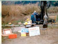
PRELIEVO DI CAMPIONI INQUINATI. BONIFICA EX AREA SIDERURGICA DI BAGNOLI (NA)
